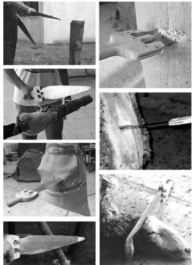
Figura 4. Distintas pruebas. a) Aplicación sobre poste estático con protección de cuero b) Aplicación sobre saco de arpillera sin protección. c) Aplicación sobre madera protegida por vellón de lana. d) Aplicación sobre paquete intestinal. e) Aplicación sobre saco de arpillera protegido con cuero. f) Aplicación sobre madera. g) Aplicación sobre cráneo de ovis .
