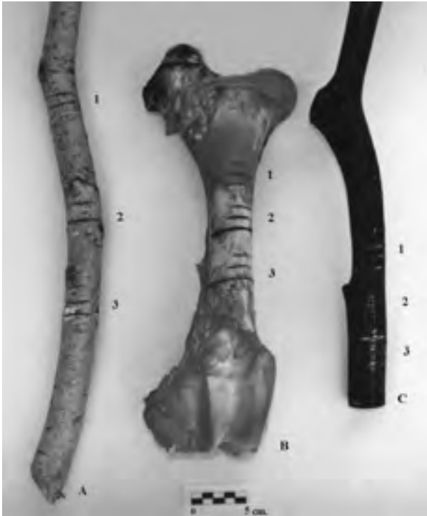
Figura 3: Materias primas sobre las que se ha realizado el aserrado. A-madera fresca de Olivo ( Olea europea , L.), B- Fémur fresco de vacuno ( Bos taurus , L.), C-Asta remojada de ciervo ( Cervus elaphus , L.). Los números 1, 2 y 3 se refieren a las huellas de aserrado de la sierra de cobre, cobre arsenicado y bronce, respectivamente.
