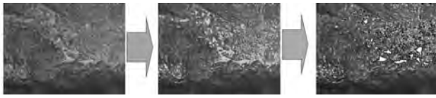
Figura 2: En la primera imagen observamos la imagen original, la segunda corresponde a la imagen con los píxeles que están dentro del intervalo entre 0 y 120 seleccionados y la tercera corresponde a los elementos de textura discriminados a partir de los píxeles seleccionados en la segunda imagen.
