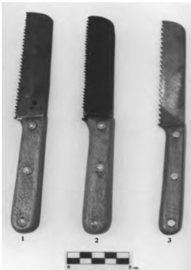
Figura 2: Sierras empleadas para la experimentación. 1- Sierra de cobre, 2-Sierra de cobre arsenicado, 3- Sierra de bronce
