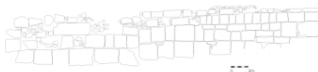
FIG. 7. Alzado frontal del basamento ciclópeo del muro de Droop.
