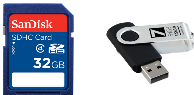
Figura 3.6: Les targetes SD i els pen-drive són memòries flash
