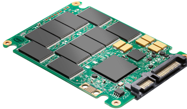
Figura 3.7: Un solid-state drive per dins
