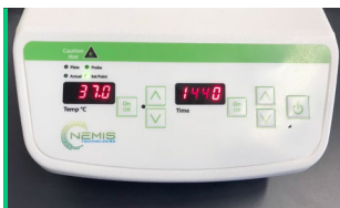
Ajuste la temperatura a 37°C y pulse <on> Ajuste el temporizador a 1440 minutos [24h +/- 1] y pulse <on>
