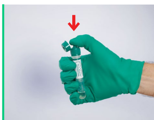
Abra la tapa de protección y pulse firmemente el botón para liberar la tableta AquaSpark™
