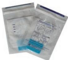
Para el óptimo muestreo de superficies. Listas para usar en una bolsa para homogeneizar, impregnadas con neutralizante para desinfectantes.
