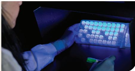
Quanti-Tray\* ofrece los recuentos del número más probable (NMP) hasta 200 por cada muestra de 100 ml. Quanti-Tray\*/2000 ofrece los recuentos del NMP hasta 2419 por cada muestra de 100 ml.
